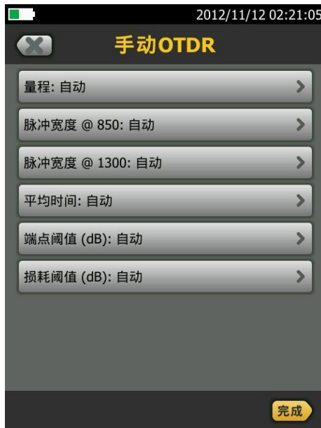
图 福禄克 OptiFiber Pro 手动 OTDR 配置界面
